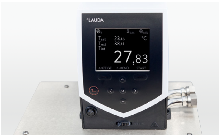
单色的LCD(Silver)显示屏使用纯文字菜单导航或者彩色TFT显示屏(Gold)使操作简单直观
